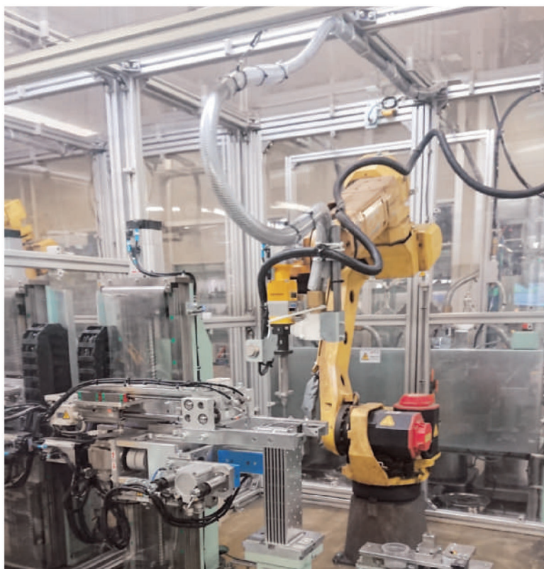
●EGRクーラーの「コア」部分の生産ライン。多軸ロボットがロウ付けをしている Ⓣ多軸ロボットでラヂエーターを検査する
