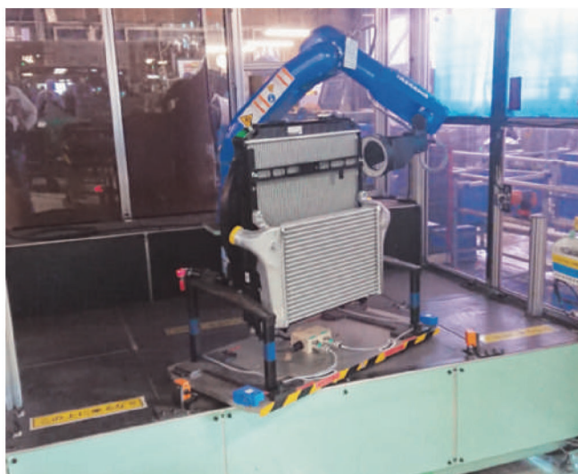
●EGRクーラーの「コア」部分の生産ライン。多軸ロボットがロウ付けをしている Ⓣ多軸ロボットでラヂエーターを検査する
